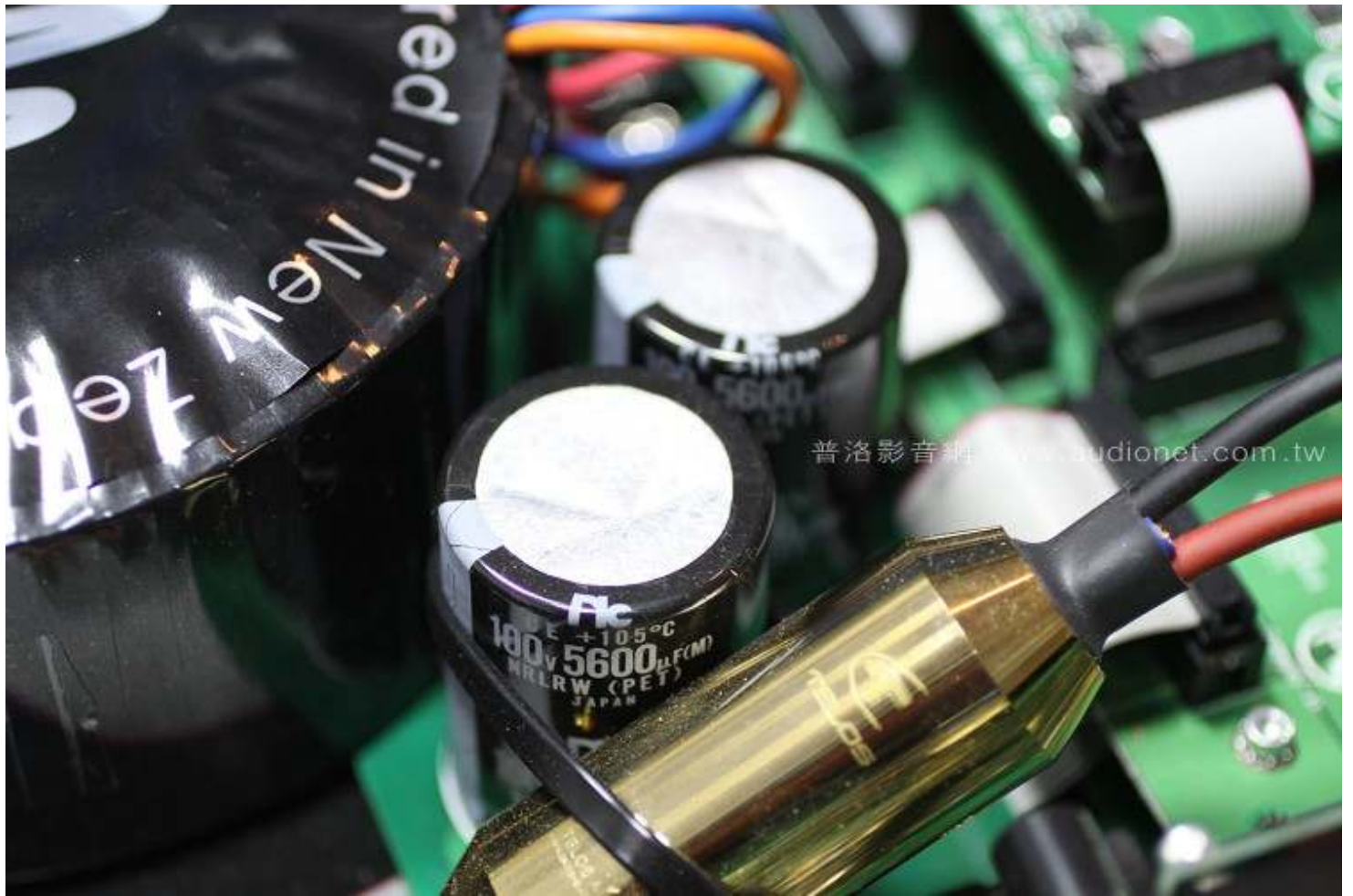
左右聲道的供電也採獨立供電，每聲道各使用了2顆5, 600 \mu F的濾波電容，瞬間供電能力不是問題。
